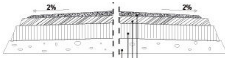
Ryc. 2: przykładowe rozwiązanie - przekrój przez nawierzchnię mineralną bez obrzeża
