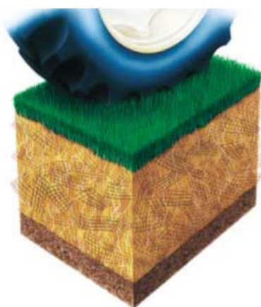
Ryc. 7: sposób funkcjonowania nawierzchni w razie obciążenia oraz widok realizacji trawnika ze wzmocnieniem za pomocą siatki polipropylenowej / fotografia – materiały producenta
